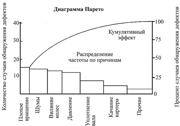
Дефекты, обнаруженные при эксплуатации автомобилей
